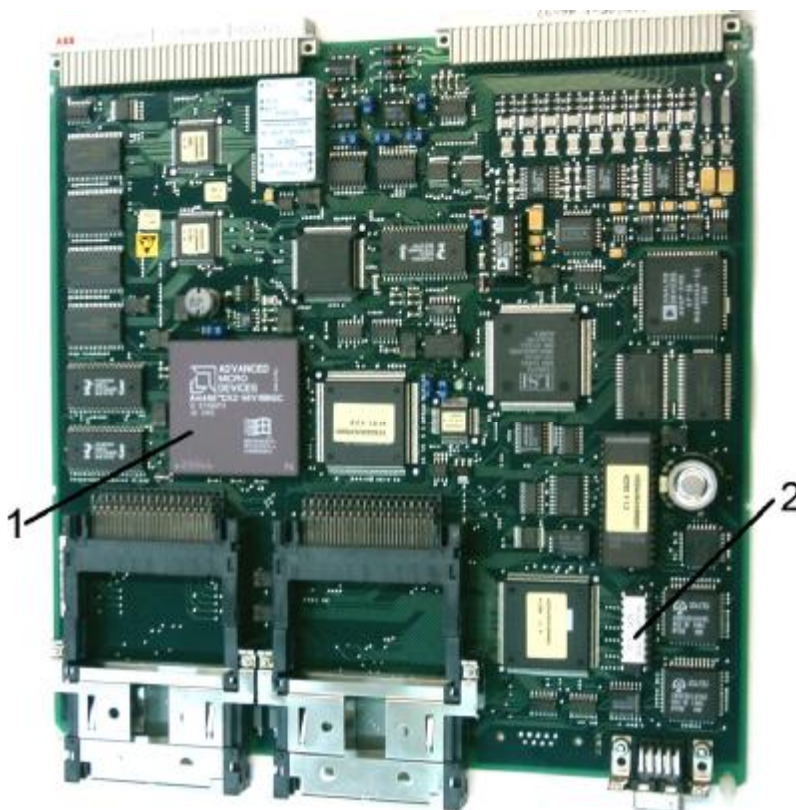
Рис. 5. Главная плата универсального микропро-цессорного реле серии RE_316*4 с установлен-ными на ней стандартным "компьютерным" микро-процессором 486 серии (1) и постоянным запоминающим устройством – "soft-ware key" (2) с программой, определяющей тип реле.
