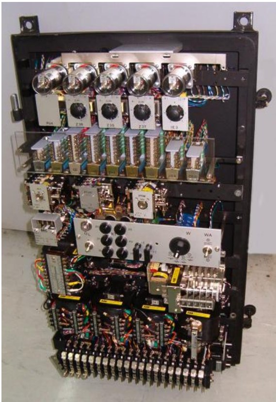
Рис. 3. Шедевр релестроения – электромеханическое реле трехступенчатой дистанционной защиты типа LZ31, выпускавшееся фирмой ASEA в 70-х годах и до сих пор надежно защищающих линии высокого напряжения 110 – 220 кВ во многих странах мира (со снятой крышкой-дверцей).
