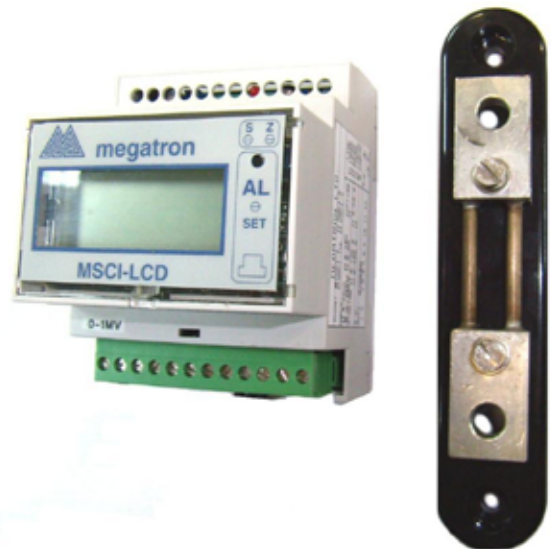
Рис. 6. Устройство для мониторинга целостности цепи подстанционной батареи, выполненное на базе стандартного шунта на ток 100 А и двух универсальных микропроцессорных приборов с релейным выходом типа MSCI-LCD компании Megatron (Израиль).
