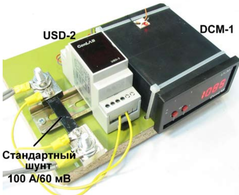
Рис. 5. Макет устройства для мониторинга целостности цепи подстанционной батареи, выполненный на базе стандартного шунта и электронных преобразователей компании Conlab (Израиль); USD-2 – электронный преобразователь входного сигнала \pm 200 мВ в выходной сигнал 4 – 20 мА; DCM-1 – микроконтроллер.
