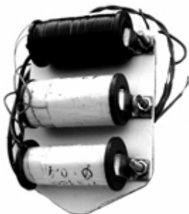
Рис. 4. Блок индуктивных датчиков тока.
