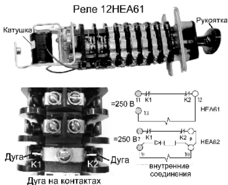
Рис. 5. Быстродействующее промежуточное реле с фиксацией положения и ручным возвратом (Lockout), 12HEA61 типа.
