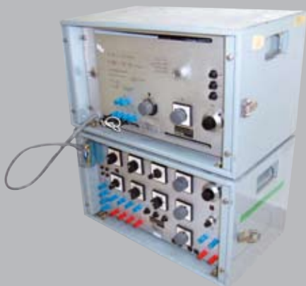
Рис. 2. Испытательная установка типа TURN-20 (ASEA) для проверки электромеханических реле защиты содержащая наборы индуктивностей и активных сопротивлений
