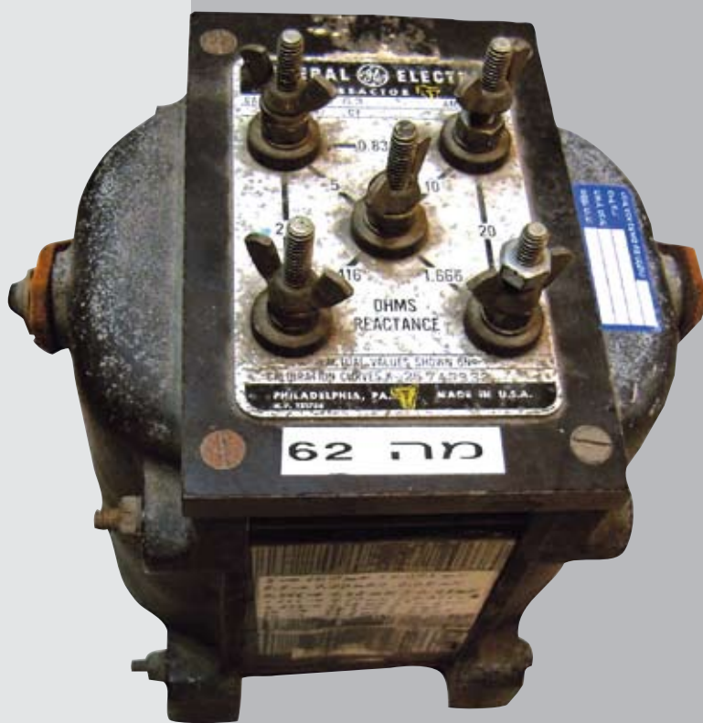
Рис. 1. Набор индуктивностей фирмы General Electric для проверки электромеханических реле защиты.
