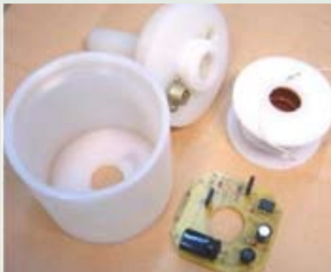
Рис. 3. Конструкция датчика повреждений высоковольтного кабеля.
