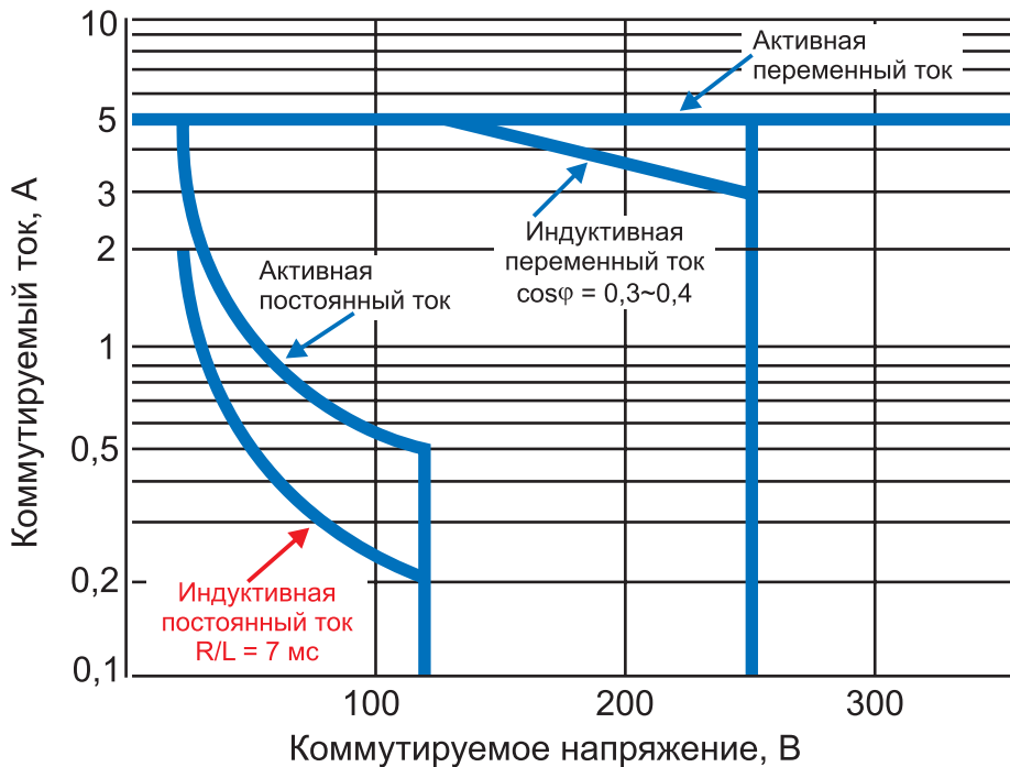
Рис. 1. Типичные кривые нагрузки контактов реле
