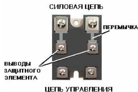
Рис. 6. Предлагаемая конструкция твердотельного реле с выведенными наружу выводами защитного элемента, подключаемого к клеммам силовой цепи посредством съемных перемычек.
