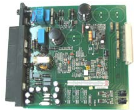
Рис. 2. Печатная плата импульсного источника питания микропроцессорной защиты, совмещающая микрокомпоненты поверхностного монтажа с крупными дискретными элементами обычного монтажа.
