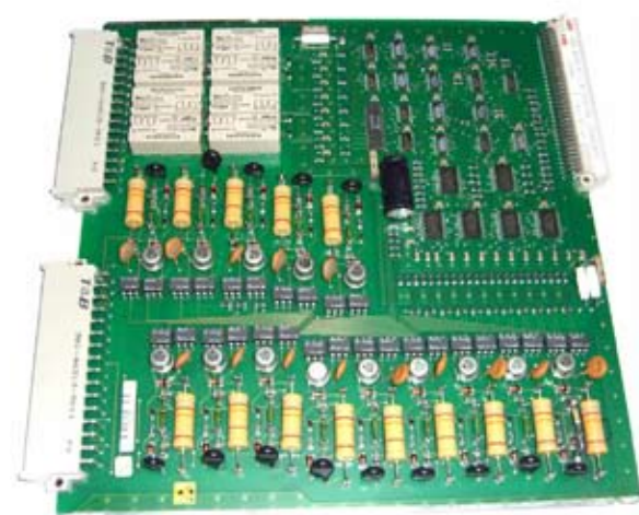
Рис. 7. Цифровые (логические) входы микропроцессорной защиты серии RE_*316: печатная плата, один канал и его принципиальная схема.
