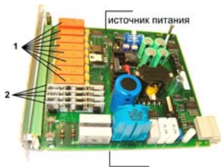
Рис. 3. Печатная плата микропроцессорной защиты, объединяющая разные функциональные узлы и выполненная полностью на электронных элементах обычного монтажа с высокой плотностью монтажа.
