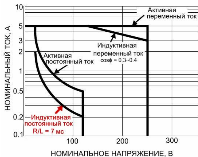
Рис. 1. Типичная коммутационная способность для различных нагрузок контактов миниатюрных электромагнитных реле, применяемых в МУРЗ.
