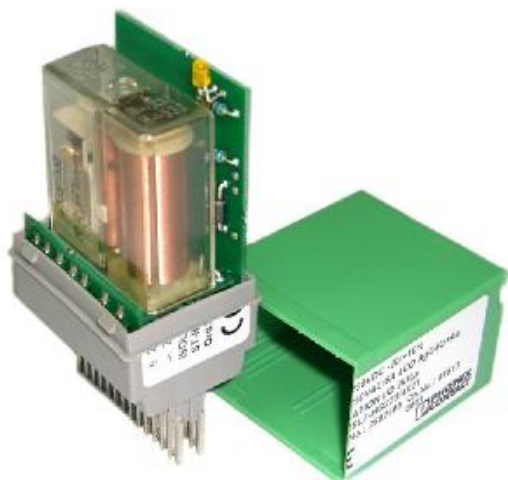
Рис. 15. Промежуточное реле типа ST-REL7-HG220/4X21 (Phoenix Contact) с дополнительными электронными компонентами, установленными на печатной плате внутри корпуса реле.
