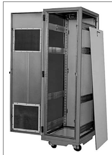
Рис. 8. Монтажный шкаф с усиленной защитой от ЭМИ, снабженный специальными петлями, прокладками из электропроводной резины, специальными стыковочными и соединительными элементами, экранированными вентиляционными окнами и т. д. (Equipto Electronics Corp.)
