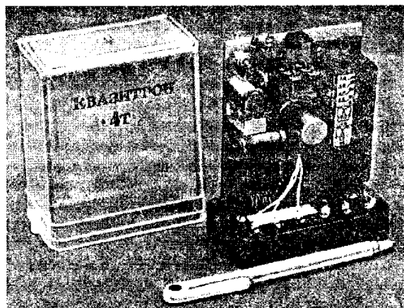
Рис. 5. Внешний вид реле "Квизитрон-4Т", размещенного в корпусе реле РТ-40
