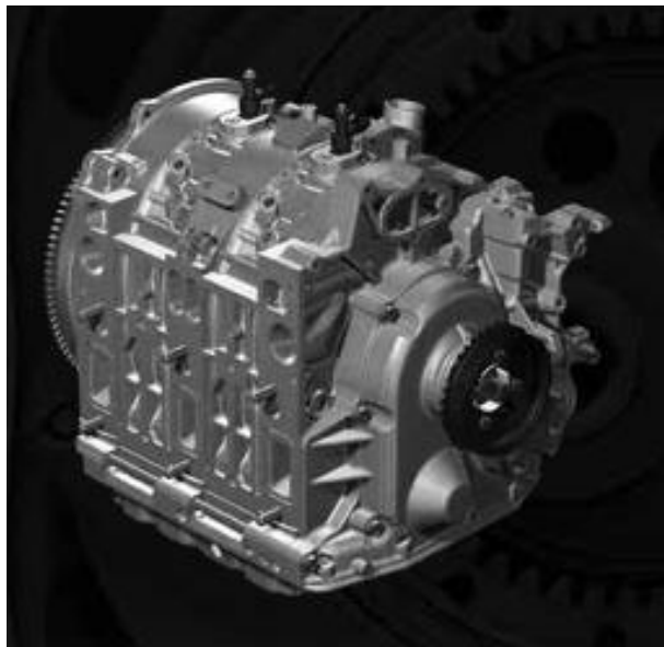
Рис. 2. Серийный автомобильный двигатель роторно-поршневого типа (Renesis-2 16X) компании Mazda
