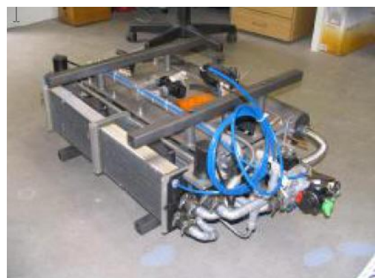
Рис. 3. Конструктивная схема и лабораторные образцы линейных дизель-электрических агрегатов, разработанных в Чехии
